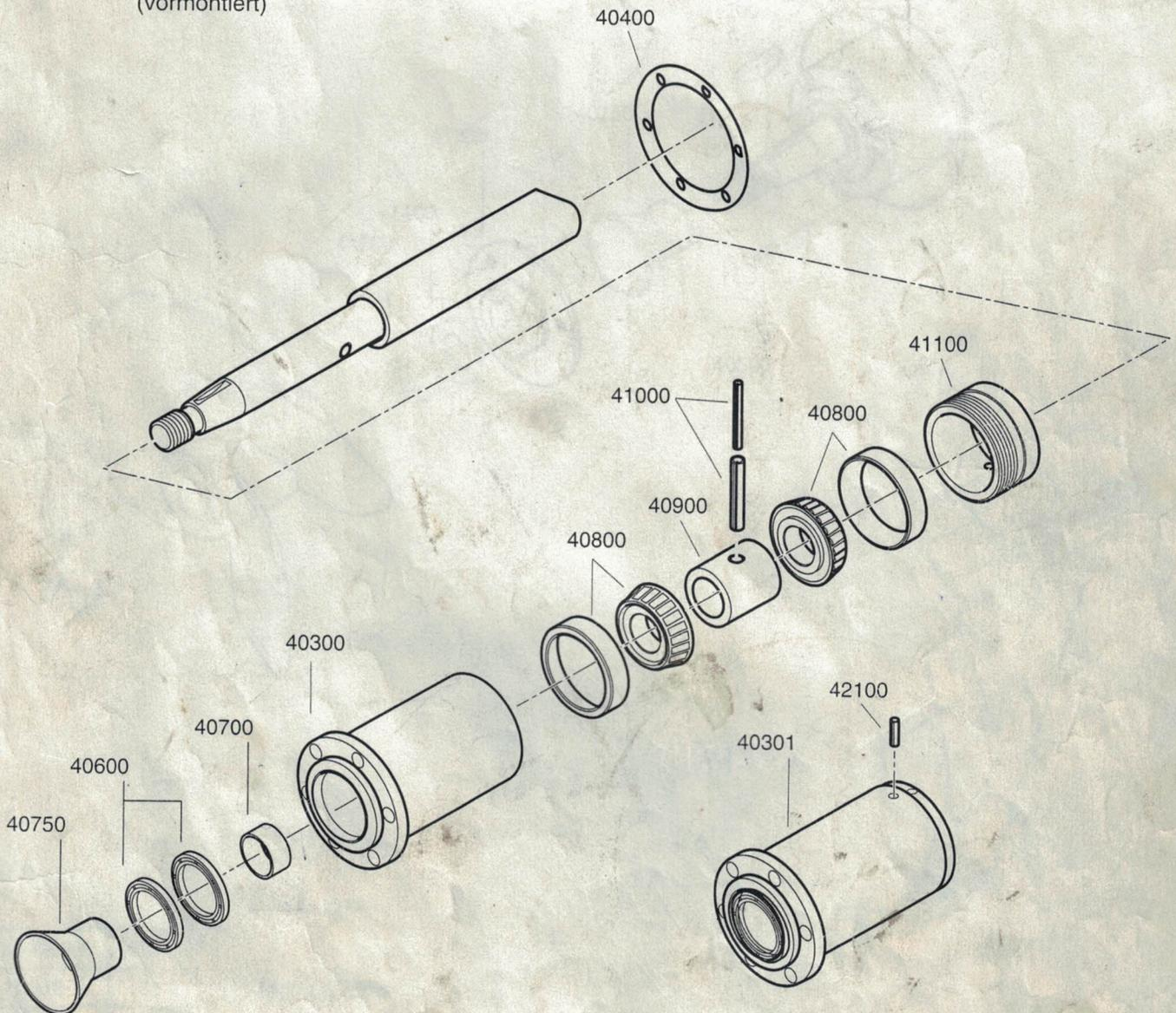
Die Dichtung für Lagergehäuse hat eine Lippe am Innendurchmesser, die zur Rührwerkrohrseite schauen muß.
