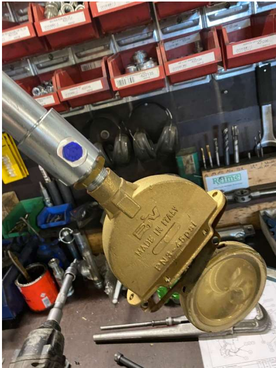
Skru sylinder helt ned, juster hydraulikk inntaket
